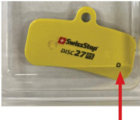
foto 2: SwissStop Disc 27RS con código de serie de producción **G**
