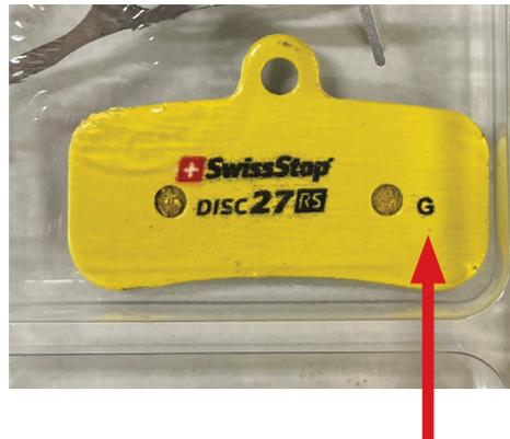
Si tiene pastillas de freno SwissStop Disc 27RS con marcas de código de producción **D** o **G**, comuníquese con su lugar de compra o con su revendedor de bicicletas para organizar el reemplazo de las pastillas afectadas. Todas las pastillas de freno de disco Disc 27RS con marcas de código de producción **D** o **G**, nuevas o usado, deben devolverse a un distribuidor de SwissStop para la sustitución.
